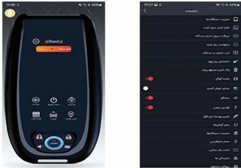
در صورتی که عملیات تعریف شماره خریدار در دستگاه انجام نشده لازم است تا شماره تلفن خریدار به دستگاه معرفی گردد تا ارتباط دستگاه با مالک آن برقرار شود بدین منظور وارد تنظیمات و انتخاب گزینه ثبت شماره در دستگاه میشویم در صورتی که گوشی مالک دو سیمکارتی است هر دو خط موبایل خریدار میبایست در قسمت شماره اول و دوم با ۹۰ وارد شود و نهایتاً با کلیک بر روی تایید از طریق پیامک به دستگاه ارسال و معرفی میگردد.
