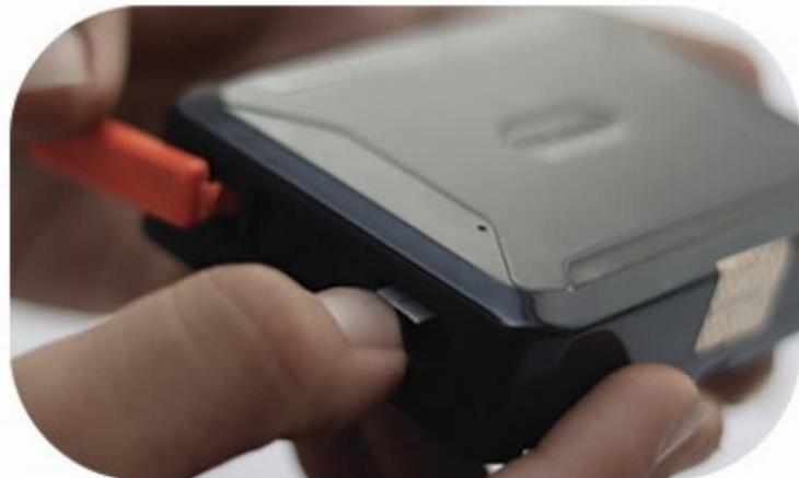
**نکته ۱ :** دستگاه دارای سنسور نور است که در سمت چسبنده آهنربا ( پشت دستگاه ) قرار دارد کاربردش این است که در صورت جدا شدن از سطح سنسور نور عمل کرده و هشدار جدا شدن دستگاه را به مالک اطلاع میدهد .
