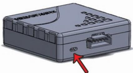
**نکته :** اگر بعد از نصب دستگاه و شارژ شدن باتری پشتیبان به هر علتی کلید باتری در وضعیت OFF قرار گیرد یا سوکت برق دستگاه جدا شود دستگاه با پیام هشدار، شما را مطلع میسازد
