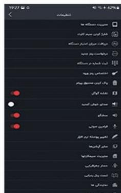
در صورتی که عملیات تعریف شماره خریدار در دستگاه انجام نشده لازم است تا شماره تلفن خریدار به دستگاه معرفی گردد تا ارتباط دستگاه با مالک آن برقرار شود بدین منظور وارد تنظیمات و انتخاب گزینه ثبت شماره در دستگاه میشویم در صورتی که گوشی مالک دو سیمکارته است هر دو خط موبایل خریدار میباشد در قسمت شماره اول و دوم با ۰۹ وارد شود و نهایتاً با کلیک بر روی تایید از طریق پیامک به دستگاه ارسال و معرفی میگردد.
